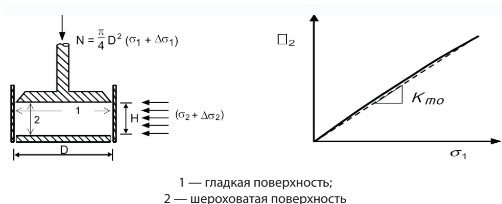
Рисунок С.3 — Метод испытаний для определения K_0
